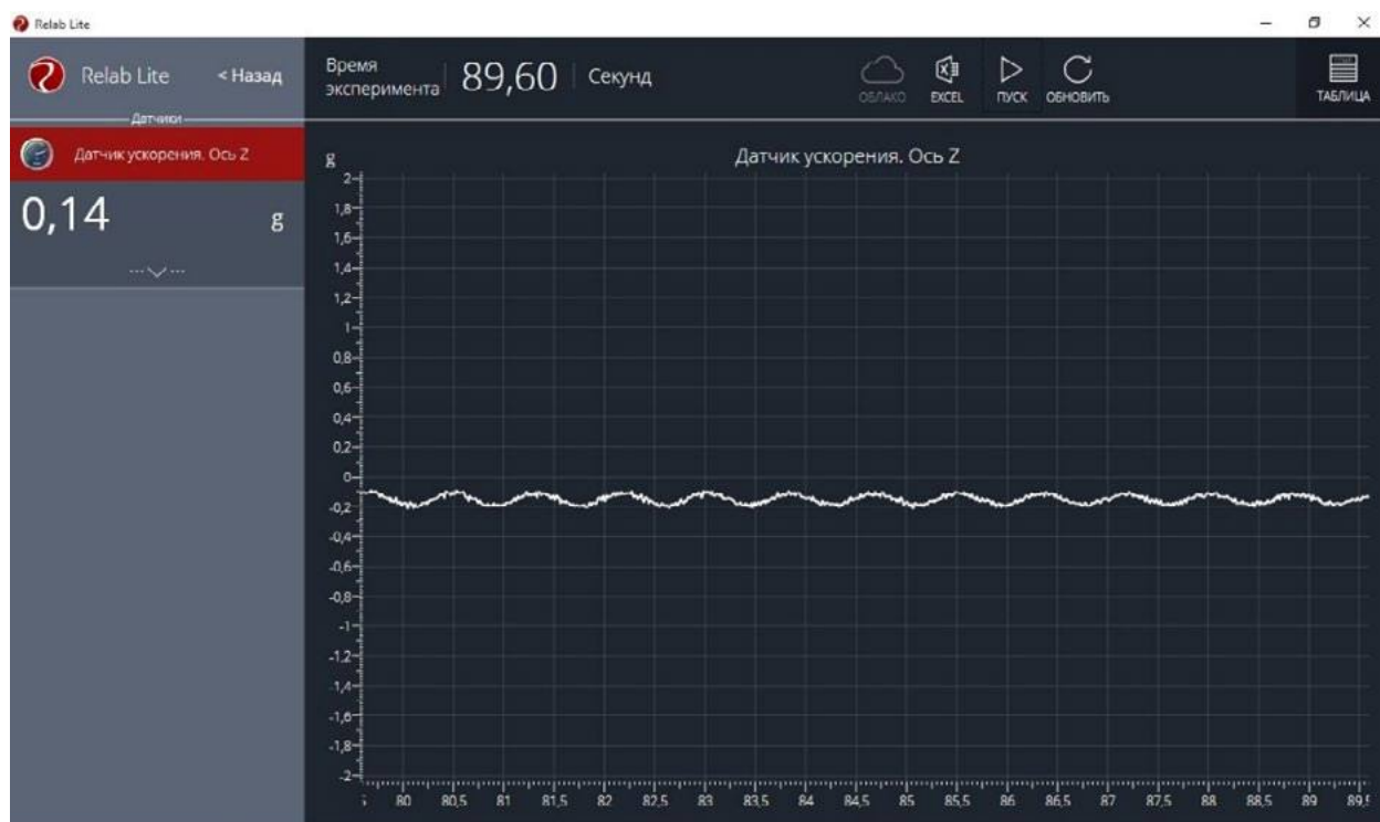
Рис. 3. График гармонических колебаний пружинного маятника
