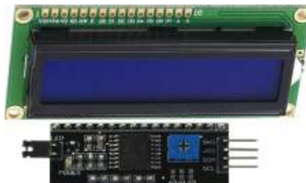
Рис. 17. Дисплей (жидкокристаллический индикатор — ЖКИ 16×2)
