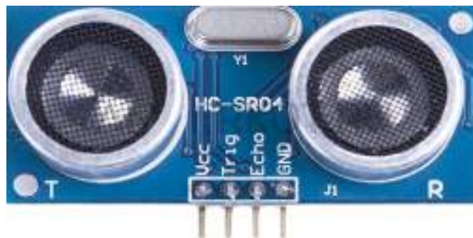
Рис. 16. Ультразвуковой датчик (дальномер)
