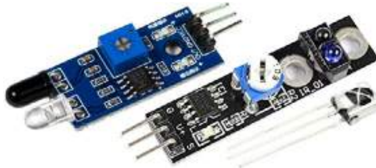
Рис. 15. Инфракрасный датчик (датчик линии)
