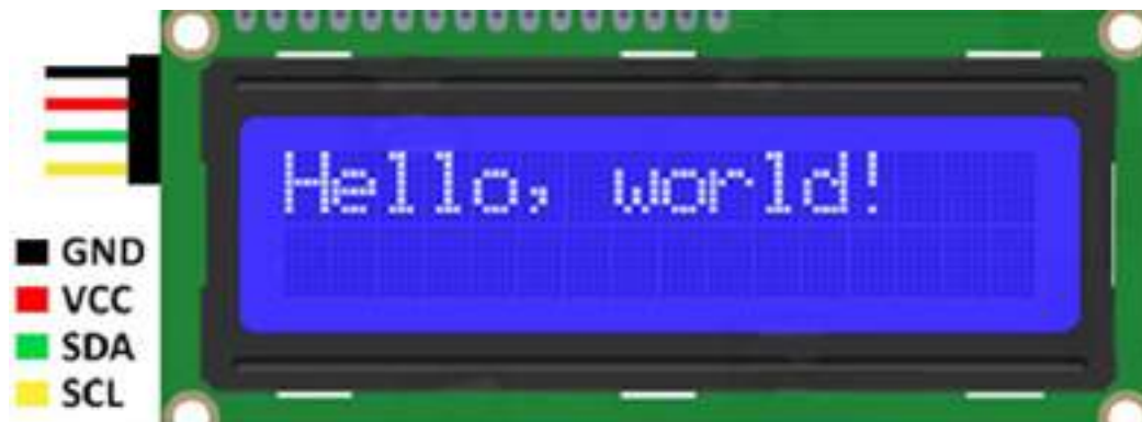
Рис. 1. Подключение модуля ЖКИ к Ардуино
