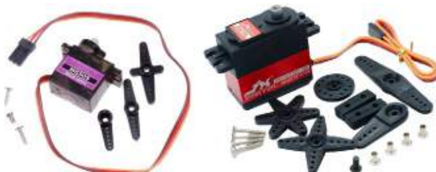
Рис. 19. Серводвигатели MG90S и PDI-6221MG-180
