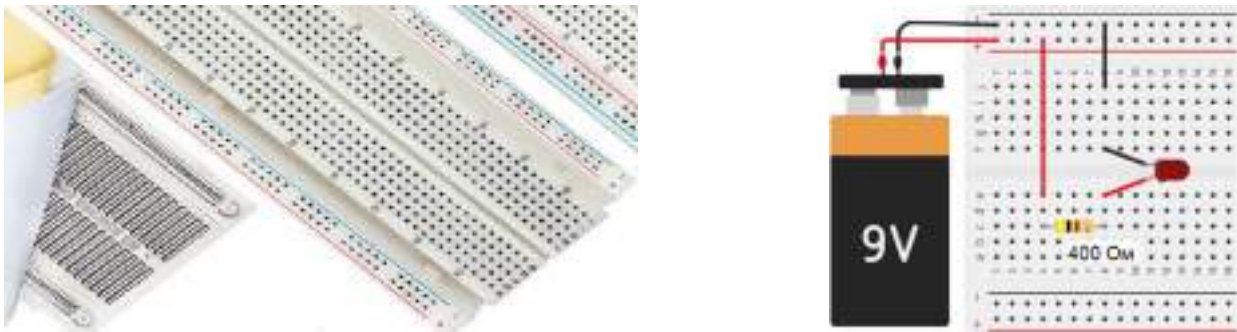
Рис. 8. Беспаячная макетная плата
